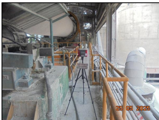
ภาพที่ 3.51 การตรวจวัดระดับความร้อนบริเวณ ทางเดินข้างแท่น 3 หม้อเผา 1
