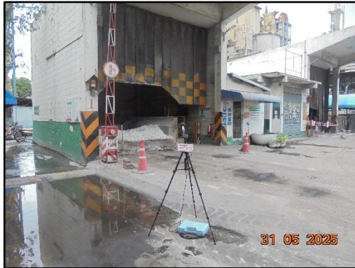
ภาพที่ 3.39 การตรวจวัดระดับเสียงบริเวณ เครื่องจักรบริเวณเครื่องย่อยหินปูน
